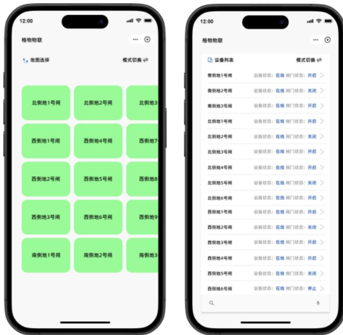
实时监控设备状态，电池电压，闸门状态，闸前闸后水位。
