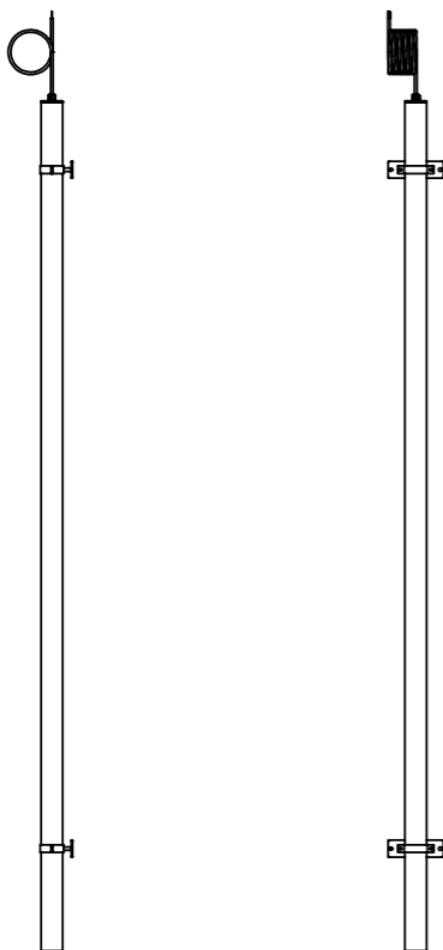
在无法进行设备侧壁打孔的城市露天道路两侧或稻田等户外场景中，推荐采用地埋式或插入式安装，并通过法兰进行加固。（具体安装方式请参考下图所示示意图）
