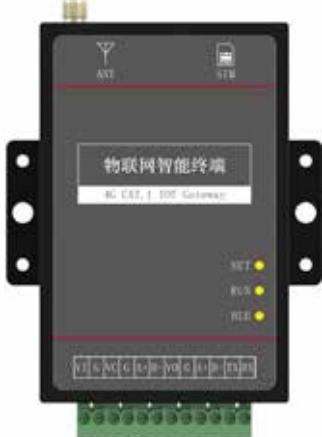
本产品针对通用数据采集应用场景，可以接入多路标准的 RS485 modbus 传感器，采集和上报逻辑灵活可设置，具备低功耗管理、传感器电源控制、内置存储等实用功能，可以方便地组建各种类型的数据监测站点。
